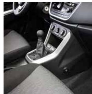
**3.19 Замок КПП для механики.** Противоугонное устройство бесштыревой конструкции. Отличается простотой в эксплуатации и удобством использования. Блокировка рычага КПП производится в положении заднего хода.
