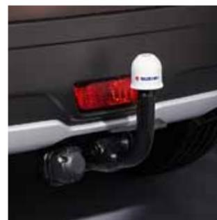
**4.11 Съёмный фаркоп.** Максимально допустимая нагрузка на крюк фаркопа: вертикальная — 50 кг, горизонтальная — 75 кг. Электрический разъем для подключения фонарей прицепа заказывается отдельно. Дополнительная информация указана в руководстве по эксплуатации Вашего автомобиля.
