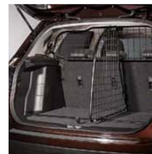
**4.9 Поперечная сетка грузового отсека.** Стальная сетка, разделяет пространство багажника на две части (только в сочетании с защитной сеткой 990E0-61M48-000).
