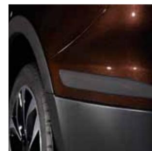
**3.16 Угловые накладки бампера.** Комплект из 4 шт. для защиты углов переднего и заднего бамперов, могут быть окрашены в цвет кузова.
