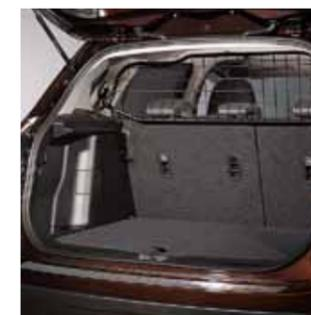
**4.10 Защитная сетка грузового отсека.** Стальная сетка, отделяет пространство багажника от кабины автомобиля.
