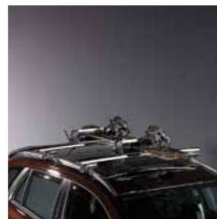
**4.3 Крепление для лыж «McKinley».** Для перевозки 4 пар лыж или 2 сноубордов (не устанавливается в комплектациях с панорамной крышей, только в сочетании с багажником 990E0-61M18-000).
