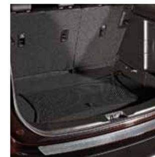
**4.14 Сетка багажного отделения горизонтальная.** Для надежной перевозки предметов под крышкой багажника.
