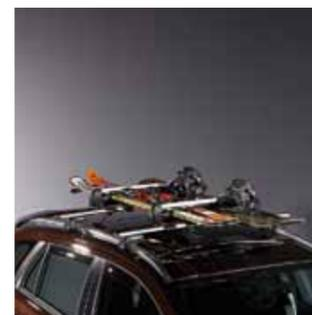
**4.4 Крепление для лыж «Everest».** Для перевозки 6 пар лыж или 4 сноубордов (не устанавливается в комплектациях с панорамной крышей, только в сочетании с багажником 990E0-61M18-000).
