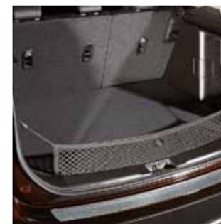
**4.13 Сетка багажного отделения вертикальная.** Защищает багаж от выпадения при открывании задней двери.
