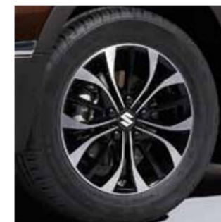
**1.5 Легкосплавный диск 6Jx16".** Для шин 205/60 R16, включая колпак центрального отверстия с логотипом Suzuki, одобрен сертификатом ECE-R 124. Серебристый. 990E0-61M70-000 Чёрный гляцевый. 990E0-61M71-000 Чёрный полированный. 990E0-61M73-000
