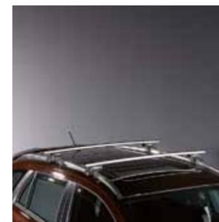
**4.5 Багажник на крышу.** Максимально допустимая нагрузка 75 кг.
