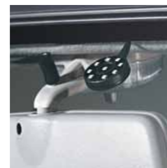
3.14 Датчик дождя. Автоматически включает дворники лобового стекла, подбирает оптимальный режим и интервал их работы. 990E0-65J81-000.
